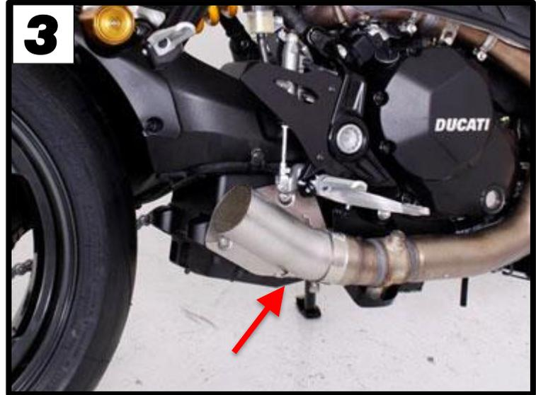
Montieren Sie den REMUS Schalldämpfer am Verbindungsrohr. Hängen Sie die beiden Federn ein, positionieren Sie den Schalldämpfer und ziehen alle Schrauben fest (Abb. 4).
